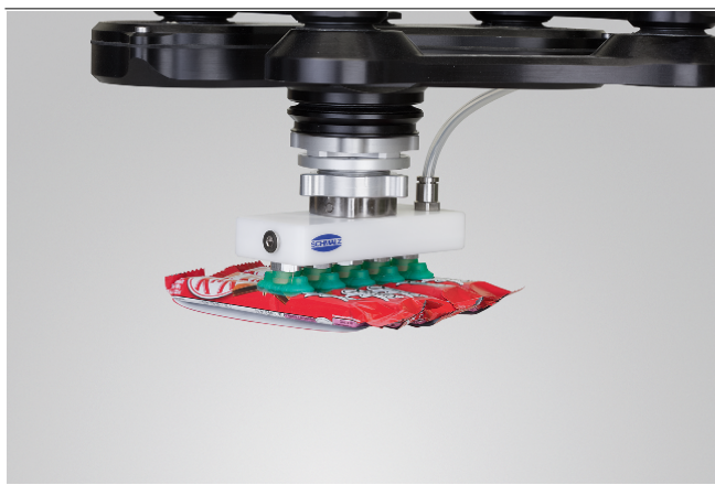
Ventosa a soffietto ovale SPOB1f per la movimentazione di imballaggi tubolari sottili
